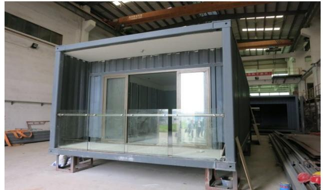
该模块使用波纹耐候钢制成。模块的外层包括铸角、接线盒、吊架和护栏，使得模块可以在海上和崎岖的道路上承受数个星期的运输。模块的内层与外部结构壳层隔开，具有良好的隔音和防火性能。模块的截面包括石膏板防火层、矿棉绝热层和铺装 EPDM 材质隔音带上的水泥纤维板或混凝土地板。每间卧室通过墙壁的空腔和地板中的 EPDM 材质隔音带与模块的外部钢壳层隔离开，因此可双重减少空气噪声传播。模块间的最小中空间距为 20 毫米，可进一步确保提供良好的隔音性能。使用集装箱的模块化建筑可使每个模块成为一个单独的防火分区，因此也显著提高了安全性。卧室间的复合界墙不仅可保证所需的稳定性，通常还超出一般的防火要求。在立面的中空部分内必须采用外部防火封堵设计，作为建筑特定围护系统的一部分。
